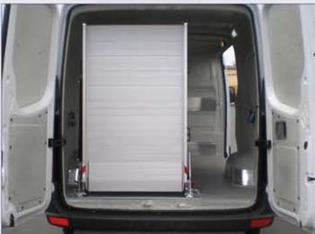
Die Ladefix-Rampen werden am Ende der Ladefläche des Fahrzeuges platzsparend und sicher verschraubt.
