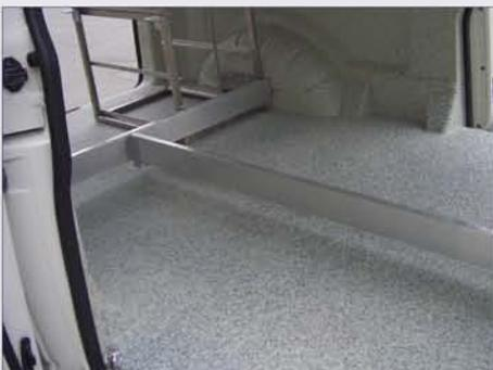
Mit steckbaren Absperrbrettern aus Aluminium am Boden lässt sich der Laderaum nach Wunsch einteilen.
