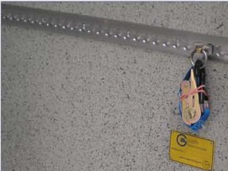
Verschiedene Zurrleistensysteme können an der Vorderwand und den Seitenwände montiert werden, um die Ladung mit Gummibändern, speziellen Ratschengurten oder Teleskopabsperrstangen zu sichern.
