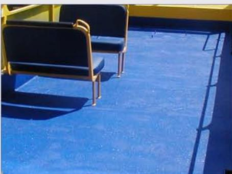
*Trans-Lining* bietet hervorragenden Abriebswiderstand, ausgezeichnete Wasserfestigkeit, sowie gute Resistenz gegen chemische und mechanische Belastungen.
