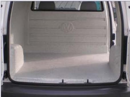
Unsere robuste Laderaumbeschichtung haftet direkt am Fahrzeugboden und formt eine dauerhafte, wasser- und luftundurchlässige, sowie rost- und korrosionsfreie Schutzschicht.
