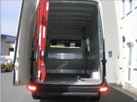
Klappbare und schwenkbare Laderampen von Ladefix erleichtern die Transportlogistik erheblich.
