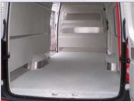
Die *Trans-Lining* Laderaumauskleidung ist leicht zu reinigen, rutschhemmend, verschleißfest und bietet eine extrem hohe Abriebfestigkeit. Sie schützt langfristig die Investition Fahrzeug und erhöht den Wiederverkaufswert.
